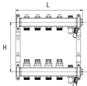
Расход теплоносителя при скорости течения 0,4 м/с – 1,53 м<sup>3</sup>/час, тепловой поток при T=50 Δt=10 K≤17,5 kW.
