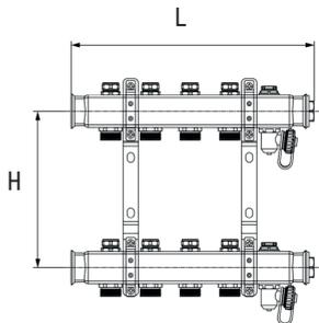
Расход теплоносителя при скорости течения 0,4 м/с – 1,53 м<sup>3</sup>/час, тепловой поток при T=50 Δt=10 Ks 17,5 kW.
