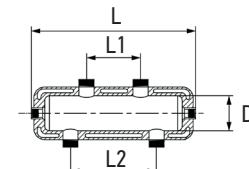
Термогидравлический разделитель представляет собой ёмкость из нержавеющей стали с вваренными разъемовыми патрубками – два с одной стороны для подключения первичного (котлового) циркуляционного контура и два с другой стороны для присоединения вторичных контуров систем теплопотребления. Кроме основных патрубков, термогидравлический разделитель снабжен штуцерами с резьбой 1/2" для установки воздухоходовика и дренажного крана. Термогидравлический разделитель имеет вертикальный вариант исполнения.
